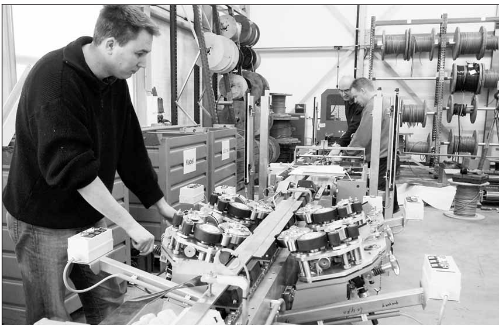
Opbouw en inregelen van een machine voor het bedrukken van eierdozen.
